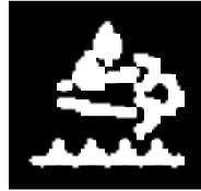
**Индикаторная лампа высокой температуры выхлопной системы (HEST)**
