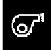
**Индикаторная лампа отклонения налево LDWS (системы предупреждения о выезде за пределы полосы движения)**
