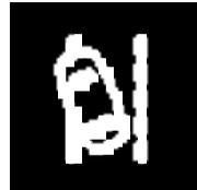
**Индикаторная лампа отклонения направо и неисправности LDWS (системы предупреждения о выезде за пределы полосы движения)**
