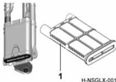
1. Фильтрующий элемент карбамидного резервуара
