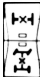
**Выключатель предупреждения о выезде за пределы полосы движения/предупреждения о лобовом столкновении**
