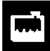
**Предупреждающая лампа остановки двигателя**
